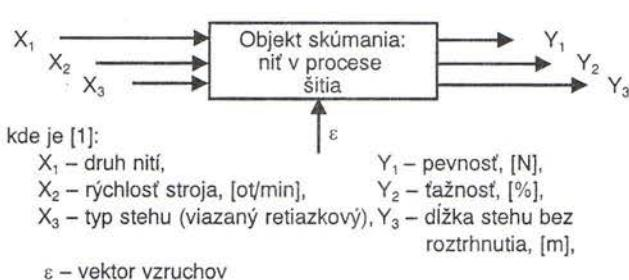
Obr. 1 Schéma objektu skúšania
