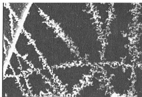
Obr. 18 Elektretový záchranný čisticí filter na nanovláknách
