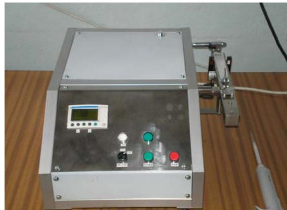
**Obr. 6** Prístroj Roltest na stanovenie uhla rolovania kvapky vody
