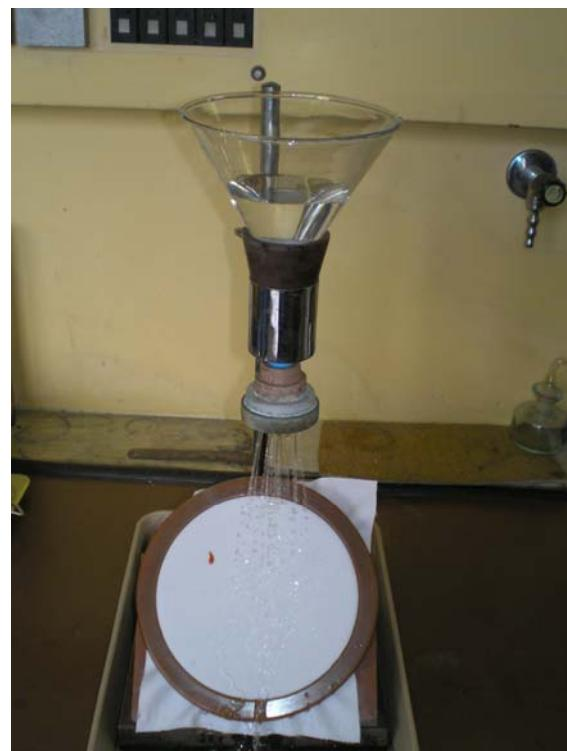
**Obr. 13** Tkanina na spray teste - kečup je prúdom vody odplavený
