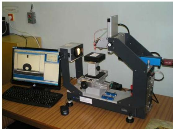
**Obr. 5** Prístroj Goniometer DSA 30 na overovanie kontaktných uhlov a voľnej povrchovej energie
