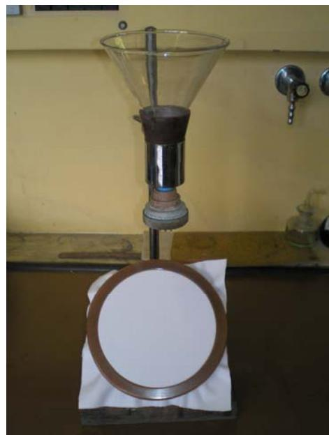
**Obr. 7** Prístroj Spray test - hodnotenie hydrofóbnej účinnosti
