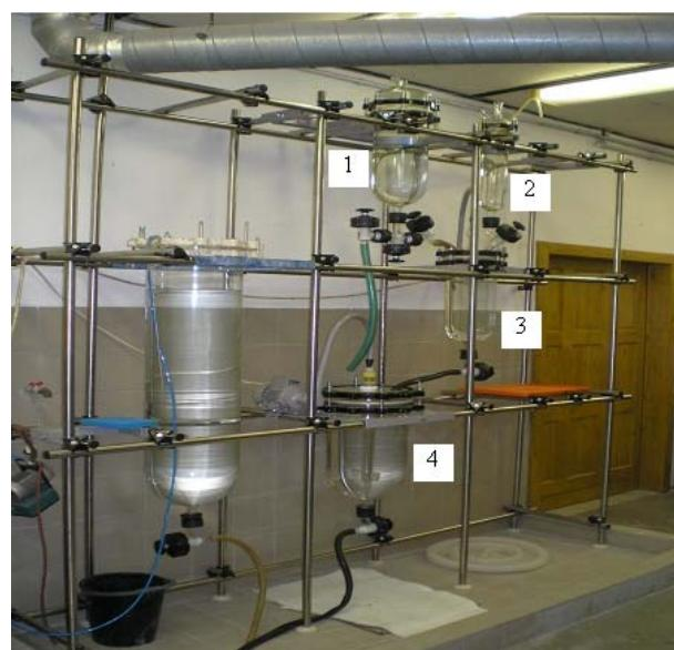
Obr. 1 Experimentálna linka na prípravu nanosólov
