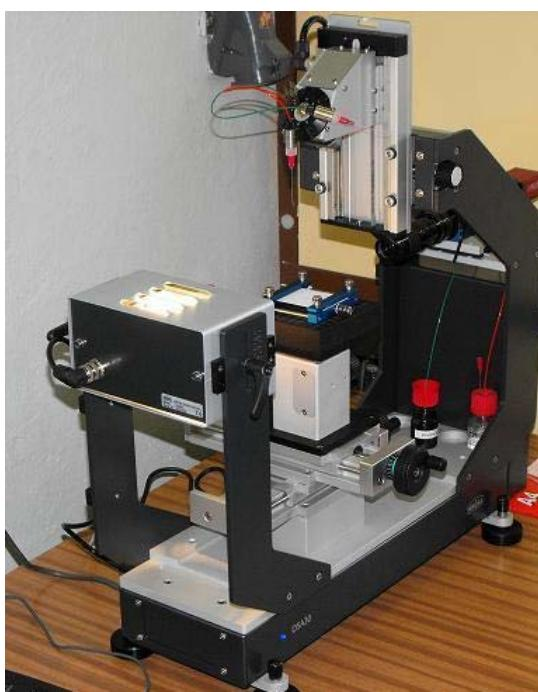
Obr. 8 Prístroj Goniometer DSA 30 na meranie fyzikálnych parametrov povrchu textílií
