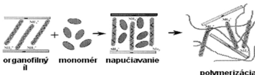
Obr. 8 In situ interkalačná polymerizácia. Molekuly polárnych monomérov difundujú medzi vrstvy
