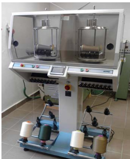
Obrázok 1 Multifunkčné zosúkovacie zariadenie Direc Twist 2B
