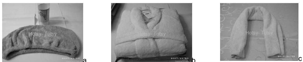
Obr.6 Konfekční výrobky z odstředivých nanovláken a) čepice, b) župan, c) šála
