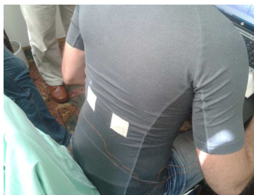
Obr. 1 Umiestnenie aktívnych textilných elektród na prvom prototypu inteligentného trička
